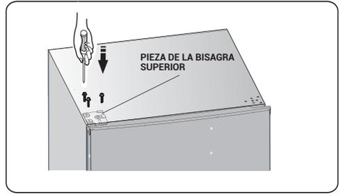
10. Instale la tapa del orificio del tornillo de la esquina superior derecha del refrigerador. Instale la tapa de la bisagra superior (que está en la bolsa de plástico) en la esquina izquierda. Coloque la otra cubierta de la bisagra superior en la bolsa de plástico.
